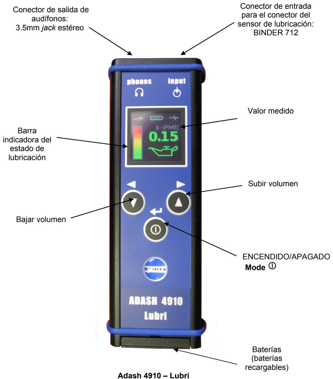
**Nota:** El equipo **A4910 – Lubri** tiene preestablecido el método de medición LB/TRUE RMS, este método es capaz de una evaluación numérica de un estado de rodamiento.
